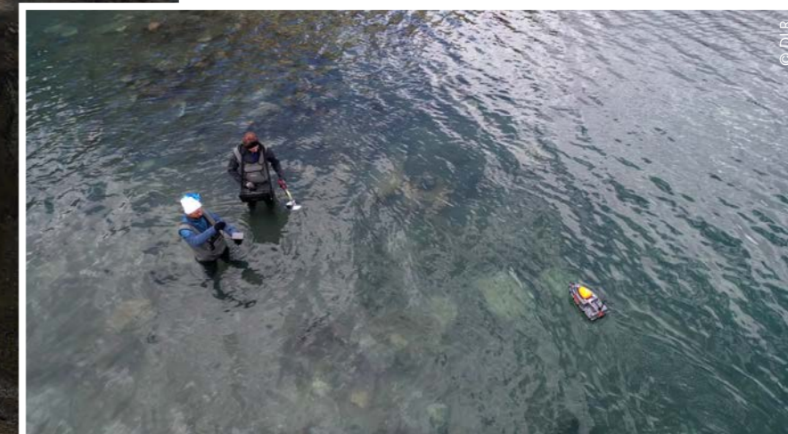
Vom Schlauchboot aus und mit Wathosen im See stehend misst das DLR-Team die Reflexionsspektren vom See Lasuntay. Das autonome Messboot erfasst währenddessen die Wassertiefe.
