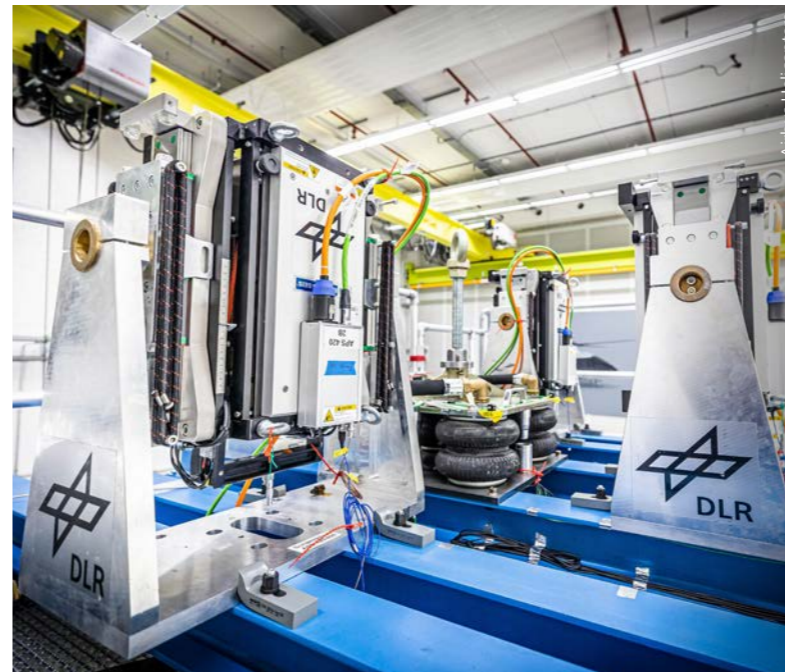
Mit solchen Shakern wird der im Testgestell aufgehängte Hubschrauber am Rotorkopf zum Schwingen angeregt.
