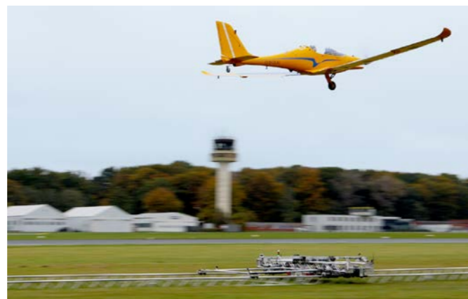
Elektra One beim Landen auf einer fahrenden Schienen-Plattform. Die Mission wird durch den Autopiloten durchgeführt, der Pilot überwacht und greift nur im Fehlerfall ein.
