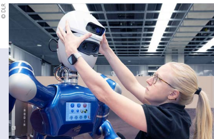
Anne Köpken und Dr. Alexander Dietrich arbeiten mit Rollin' Justin. Der humanoide Roboter hat Joberfahrung mit dem All und auf der Erde. Das Spezialgebiet von Alexander Dietrich ist die Regelungstechnik. Sie sorgt dafür, dass die humanoiden Roboter sich koordiniert bewegen.
