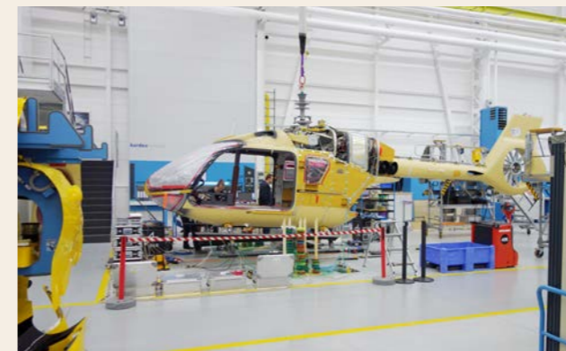
Vor Ort testeten die Forschenden die Vibrationen des Hubschraubers in verschiedenen Bauzuständen. Daraus erstellten sie verbesserte Simulationsmodelle.
