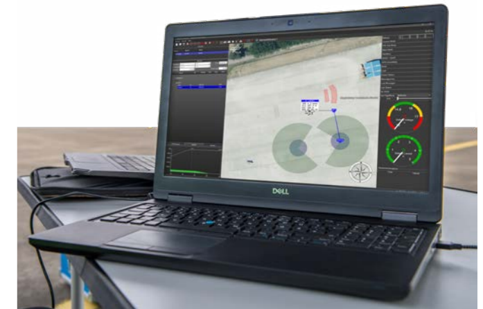
Ansicht der U-Fly-Software, einer Entwicklung des DLR-Instituts für Flugführung. Sie dient zur Kontrolle und Überwachung unbemannter Fluggeräte (kleinere UAV oder Lufttaxis). Hier können Routen geplant, Flüge freigegeben oder umgelenkt werden.
