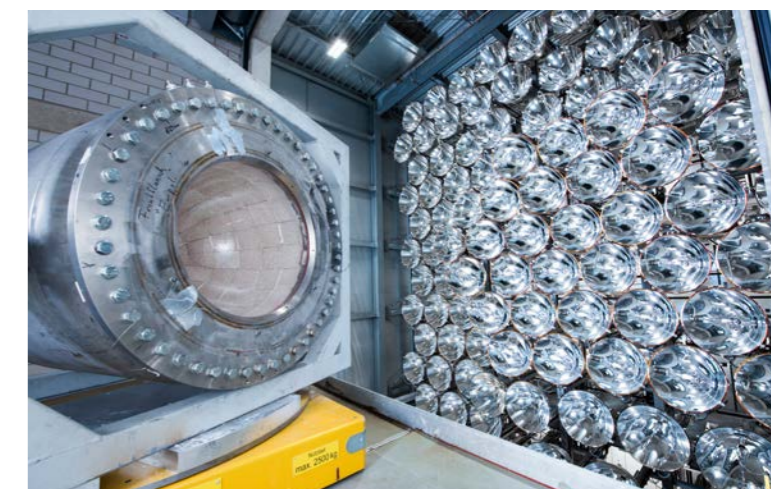
Reaktor zur thermischen Wasserstoffherzeugung
