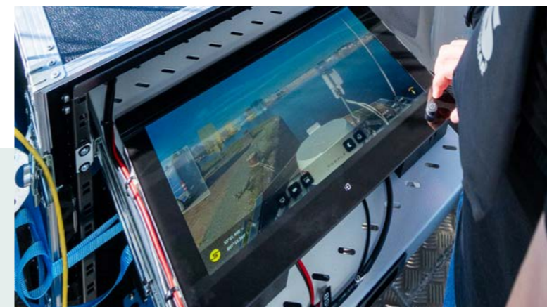
Die Technik an Bord von Sally kann Hindernisse eigenständig erkennen und auf einem Monitor anzeigen. Aus dem zur Schiffsbrücke umgebauten eMir-Container steuerten die Forscher das Boot aus der Ferne.
