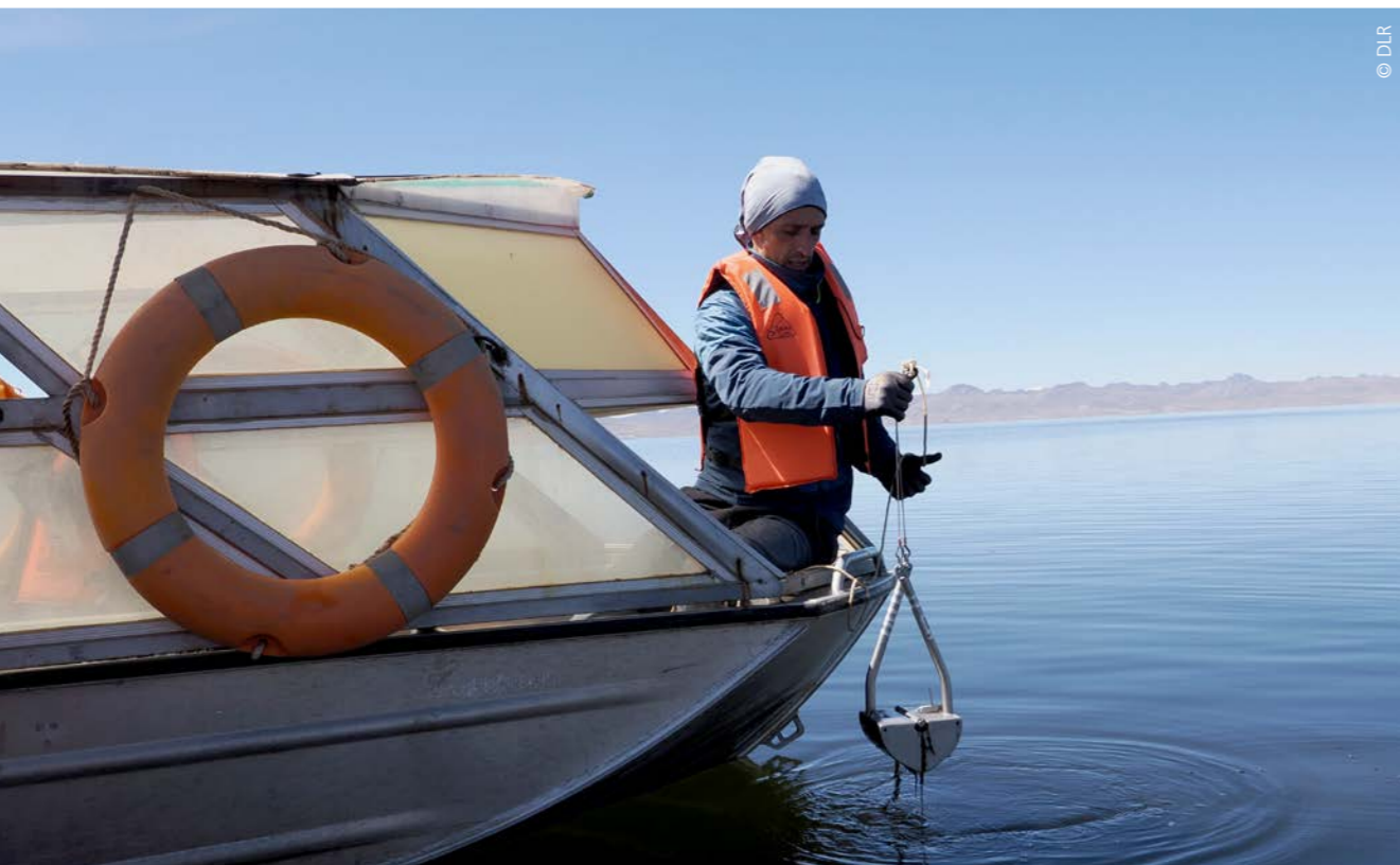
Mit einem Greifer nimmt Ian Somlai Schweiger Proben vom Boden des Lago Chinchaycocha.
