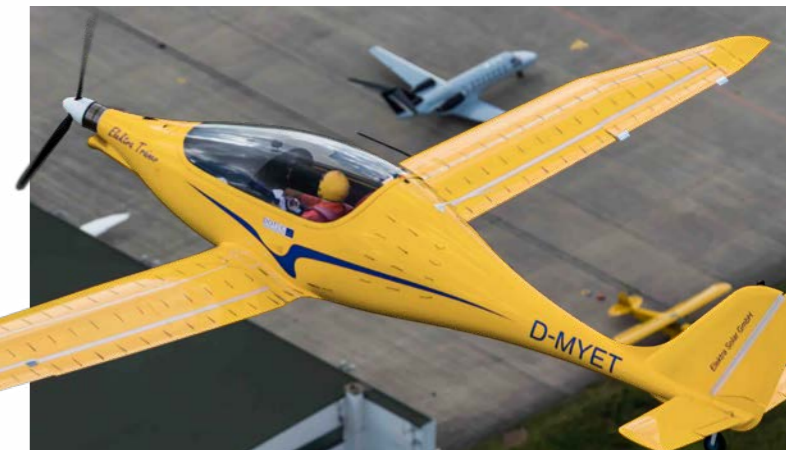
Der Elektra Trainer ist mit unter 50 Dezibel so leise, dass die Zulassungsstelle zuerst dachte, die Messinstrumente seien defekt. Die Lärmmessung wurde dreimal wiederholt, um das Ergebnis zu verifizieren.
