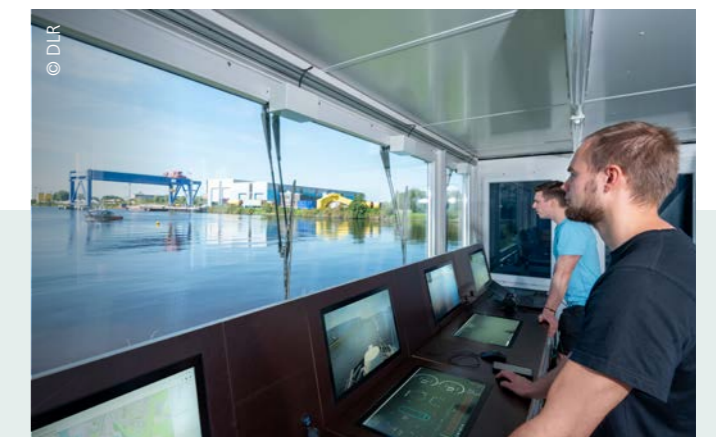
Die Technik an Bord von Sally kann Hindernisse eigenständig erkennen und auf einem Monitor anzeigen. Aus dem zur Schiffsbrücke umgebauten eMir-Container steuerten die Forscher das Boot aus der Ferne.
