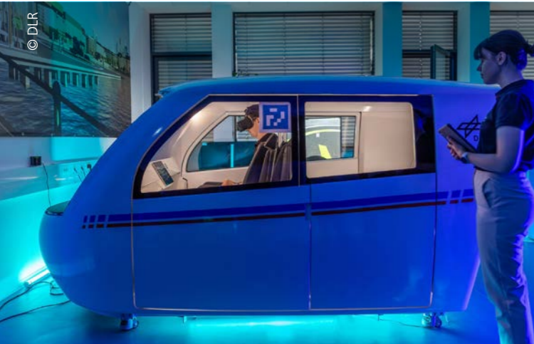
In diesem Kabinensimulator des DLR-Instituts für Flugführung unternahmen Probandinnen und Probanden einen virtuellen Lufttaxi-Flug.
