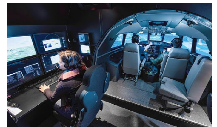
Das ISTAR-Cockpitmodul bietet geräumige Operator-Plätze zur Beeinflussung der Simulation und Szenerie.
